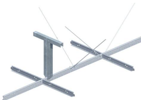
Componenti in opera del sistema di controventatura
